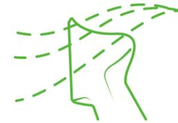
風速が20m/secを超える強風時には、ブレードのピッチ角を最大90度まで調整
